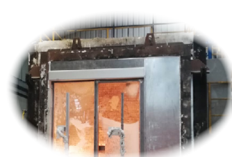
Prueba de fuego puerta corredera vidriada clasificación EW60
