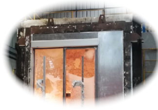
Prueba de fuego puerta corredera vidriada clasificación EW60
