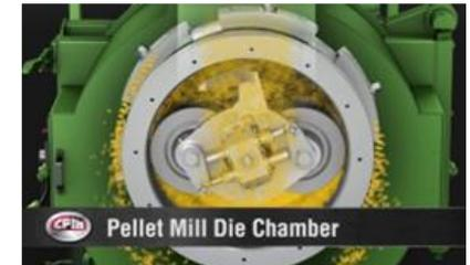
Máquina fabricar pellets
